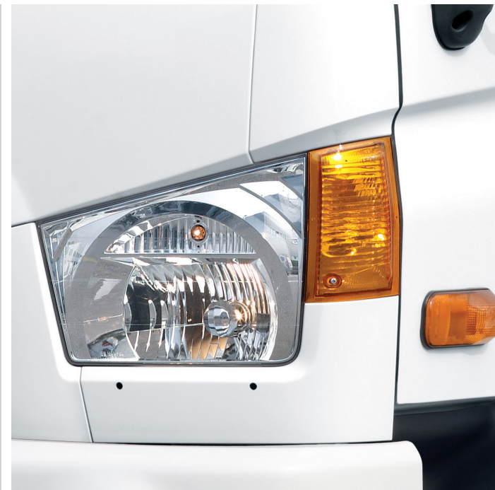
Đèn pha với chóa phản quang tăng khả năng chiếu sáng tối đa
