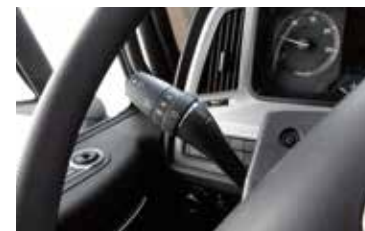
Cần gạt tích hợp nút điều khiển
